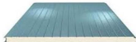
En fachada, utilizamos panel sándwich machihembrado de espesor 40mm, compuesto por 2 chapas de acero galvanizado y prelacado y núcleo aislante PUR/PIR. Transmitancia térmica 0.53W/m<sup>2</sup>·k. Densidad media relleno 40 Kg/m<sup>3</sup> (±10%).
