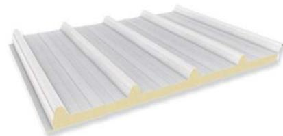
En cubierta se utiliza panel sándwich de doble chapa grecada de 5 grecas de acero prelacado, núcleo aislante PUR/PIR, de 30mm de espesor y sistema de fijación mediante tornillería vista autotaladrante galvanizada de acero.
